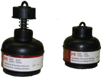
Chambre d'ionisations avec électret (configuration LT)
